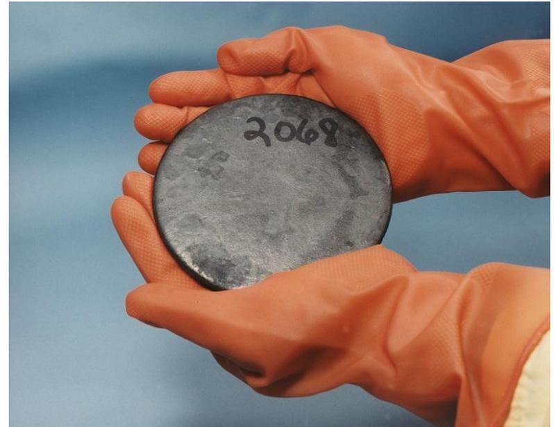
**Bild:** reines Uran, 1dm<sup>3</sup> wiegt 18,9kg!
