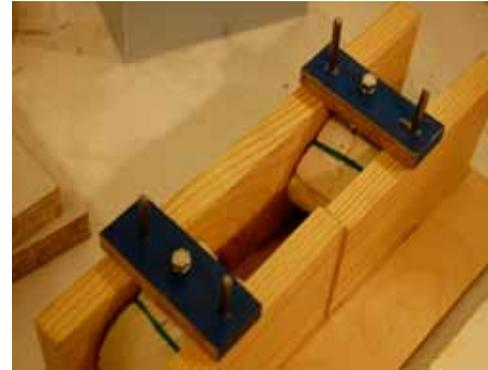
Um Gewindeschneiden zu ersparen, wird die später benötigte Schraube von oben mittels Halterung hinein gesenkt und mitgegossen. Abnehmbar, weil Gießen sonst unmöglich.
