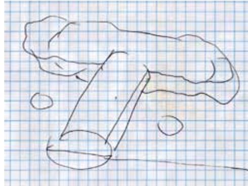
Um den Griff später gut fassen zu können, muss zur Ladenblende hin noch ein zylindrisches Stück eingefügt werden. Dazu wird die Erdnuss komplett mit Ton umhüllt, ein Zylinder wird aus dem Ton ausgestochen und mit Gips ausgegossen.
