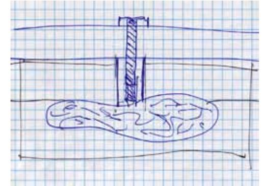
Der Gipszylinder wird mit Superkleber an der Nuss befestigt, für diesen Kombiteil wird eine zweiteilige Gießform hergestellt, siehe Zeichnung rechts.
