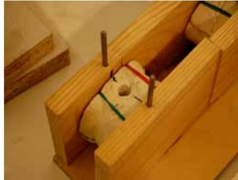
Aus Holz wird ein Ständer gebaut, der die Form möglichst knapp aufnimmt.
