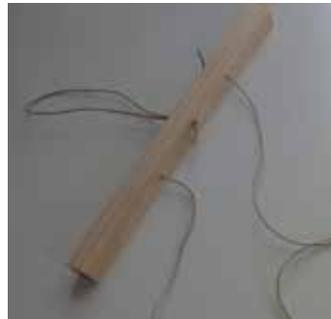
Jetzt wird die Aufhängung erzeugt. 3 Löcher mit Durchmesser 2mm in die Leiste bohren,
