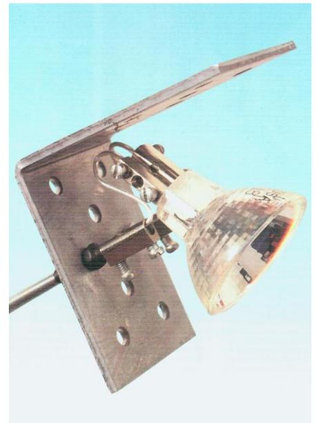
Halogen-Schreibtischlampe, einfachste Bauart mit Halogen-Spot (Niedervolttechnik 12 V), Lüsterklemmen, Gestell aus zwei gebogenen Gewindestäben, mit Plexiglas- Abstandshalter, Metallwinkel als „Reflektor“, Fuß aus Marmorfliese und Metallwinkel. Aus: Johannes R. Felix: Lichteffekte mit Halogen. Niedernhausen: Falken V. 1992
