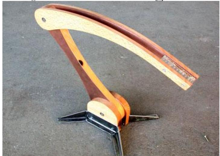
Lampen-Projekt von Thomas Stöckl in der 9.Jgst. im GtB-Unterricht Bayern von der ersten Design-Skizze über 3D-CAD- Zeichnungen bis zur Fertigung. Die verstellbare Schreibtischlampe mit 10 LEDs besteht aus zwei Armen aus Buchenholz und einem Holz/Metall-Fuß. Die LEDs wurden in einem Acrylglasblock zusammengefasst. Die Stromversorgung erfolgte durch ein Handy-Netzgerät. (2005)
