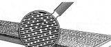
Querschnitt durch ein Tonband. Oben: Schicht aus magnetisierbaren Pigmentteilchen und Bindelack. Unten: Trägerfolie aus Polyester
