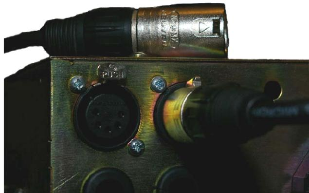
Abb1: 5pol-DMX-Stecker und Kabel
