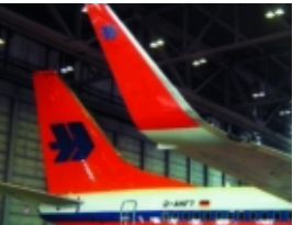
Die neue Form der Tragflächenspitzen sparen Treibstoff
