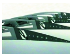
Das so genannte Fingermodell: einzelne Finger bewegen die Hinterkante der Tragfläche
