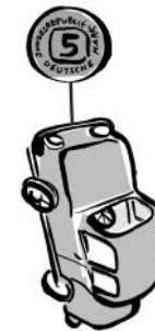
Ein zusammengeklebter Zylinder vom Durchmesser eines Fünfmärkstücks reicht, um ein 1,2 Tonnen schweres Auto zu heben.
