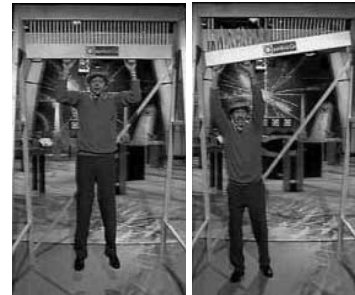
Werden alle Papierstreifen gleichmäßig belastet, ist der Klimmzug kein Problem (links); am Rand reicht schon eine kleine Belastung und die Papierstreifen reißen.
