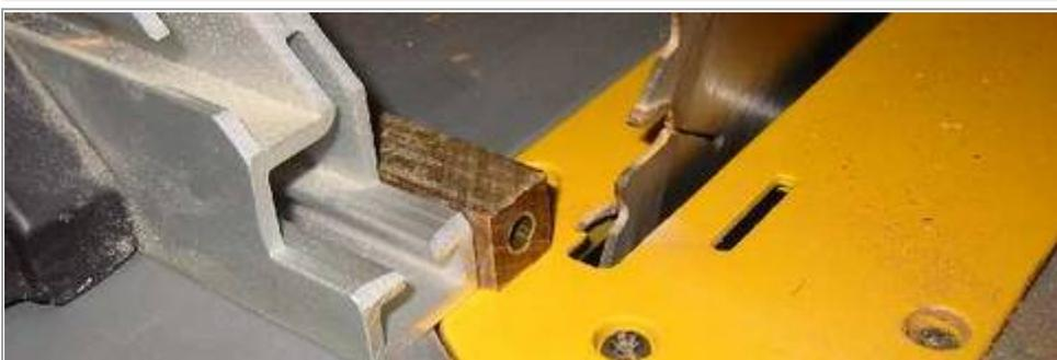
Wenn der Sekundenkleber abgebunden ist - am besten am nächsten Tag - schneide ich mit der Kreissäge das Holz zur Messinghülse bündig ab. Im Idealfall ist das Holz dann genau so lang wie die Hülse.
