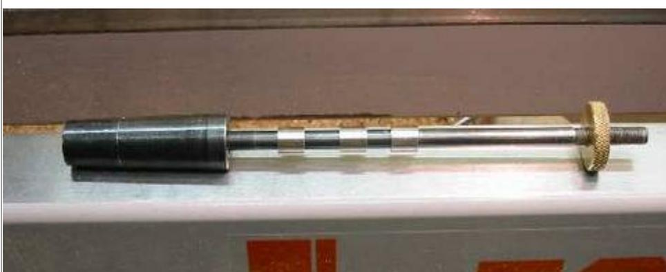
Diese Mandel ist notwendig, um die Holzrohlinge sicher und zentriert aufzuspannen. Die Mandel kostet etwa 30 Euro, eine einmalige Ausgabe. Man sollte sie nur einsetzen, wenn die Spindel durchbohrt ist, denn sonst kann es passieren, dass man den Konus nicht mehr aus der Spindel herausbekommt.
