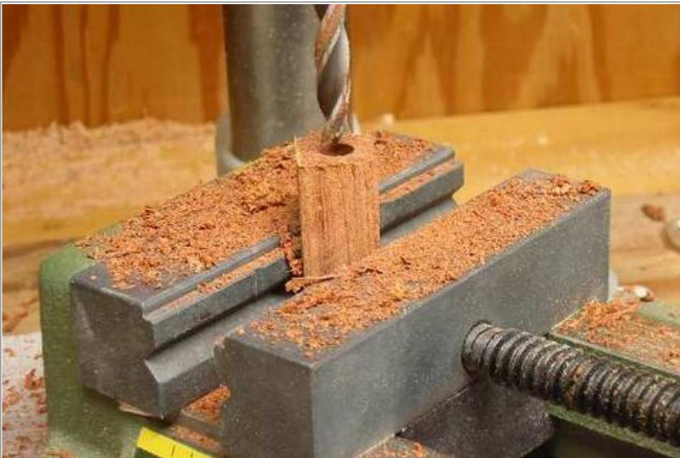
Wenn der Maschinenschraubstock am Bohrständer gut festgeschraubt wird, braucht man nur bei einem Rohling den Mittelpunkt finden. Die übrigen Rohlinge werden alle gleich eingespannt.
