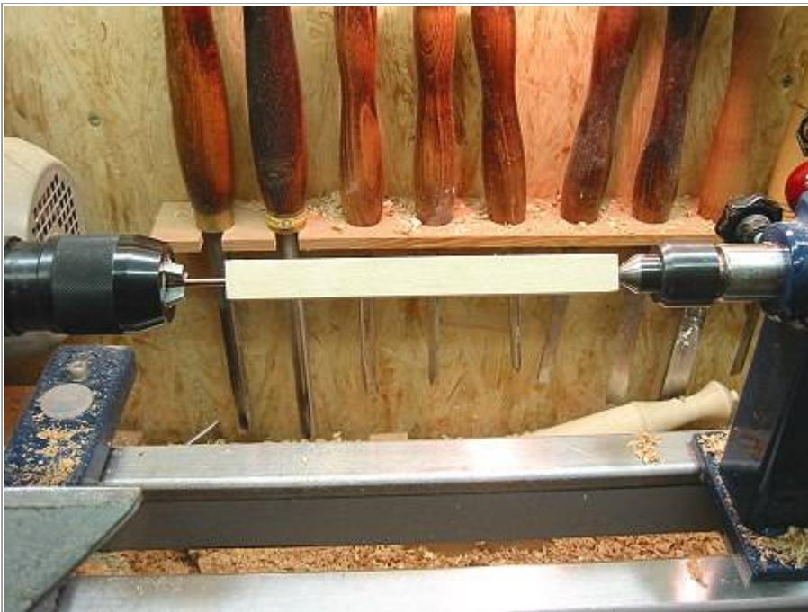
Der Schweißdraht wird nun in das Bohrfutter gespannt und der Rohling darauf geschoben. Nun kann man bequem zwischen den Spitzen einen Stift nach Lust und Laune dreheln.
