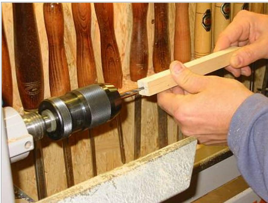
Man kann das Loch nicht auf einmal bohren, da der Bohrer sonst viel zu heiß wird, weil die Späne nicht richtig abtransportiert werden.
