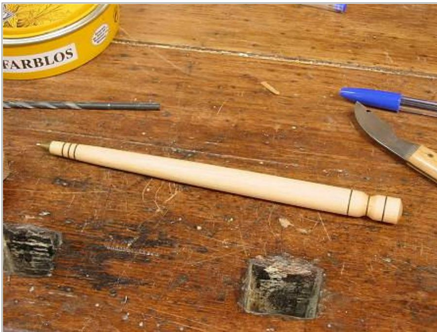
Die Mienen, die mir zur Verfügung standen, hatten ein klein wenig Spiel in der 4 mm Bohrung, so dass ich sie mit einem Tropfen Sekundenkleber im Holz fixiert habe.
