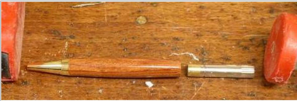
Anschließend wird die Drehmechanik in das Unterteil eingedrückt.
