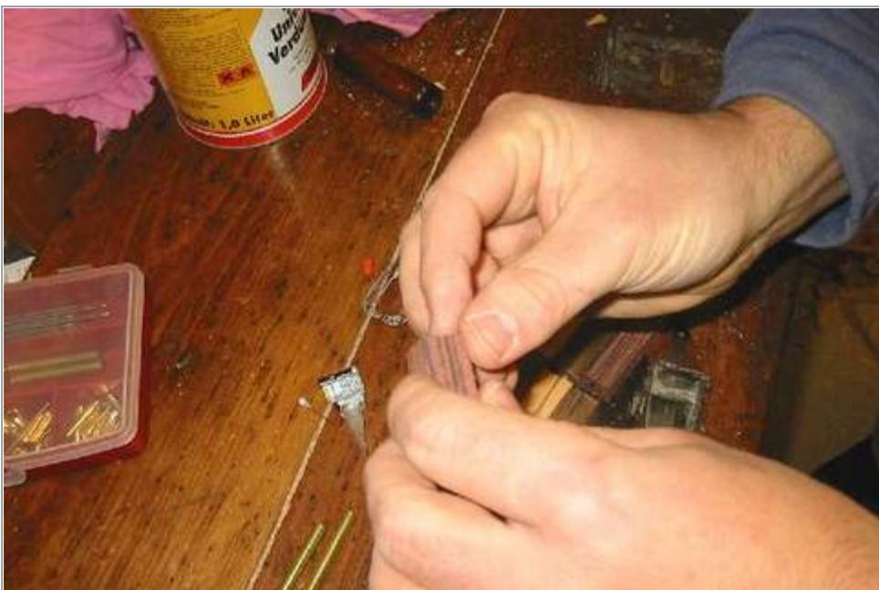
Die Hülsen werden dann vollständig in das Holz eingeschoben.
