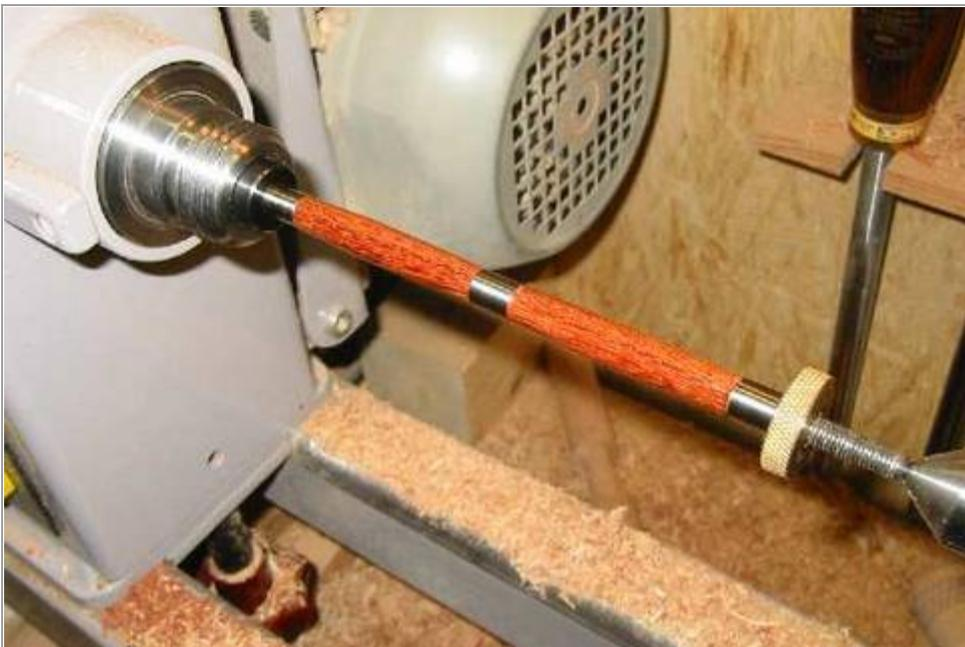
Nun ist die Drechselarbeit schon fertig. Auf der Maschine kann man auch gleich die Oberflächenbehandlung fertig machen.
