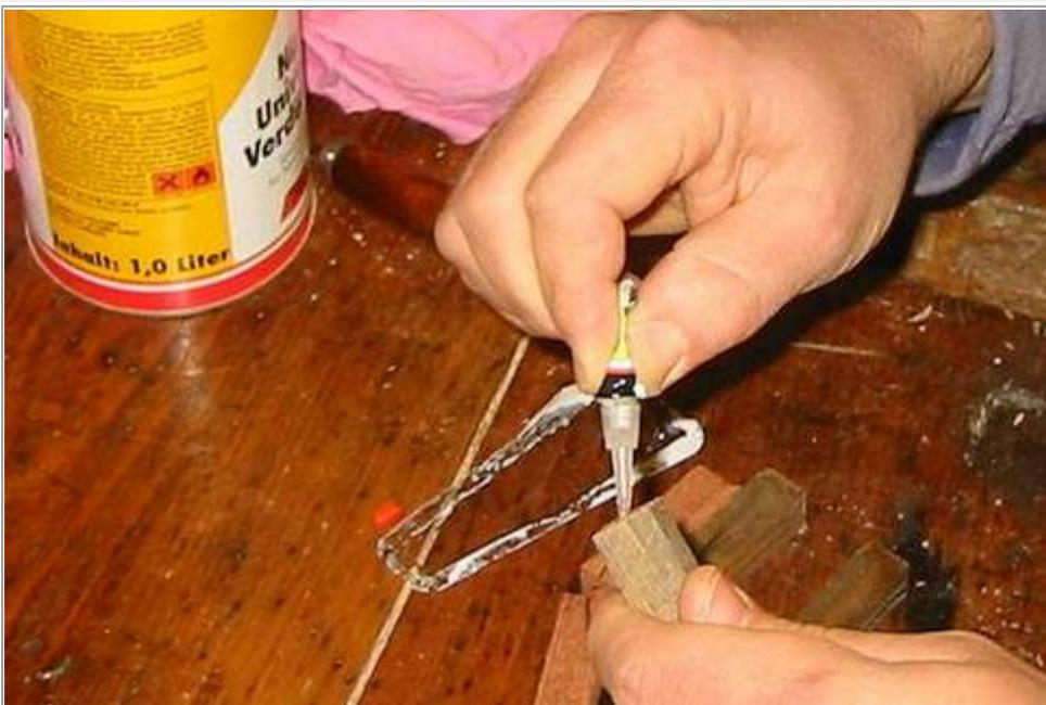
Mit Sekundenkleber werden die Messinghülsen in das Holz eingeklebt. Vorher werden die Messinghülsen mit Nitroverdünnung von Fettrückständen gereinigt.
