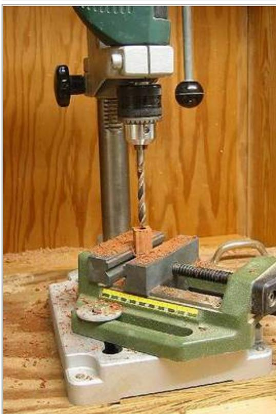
Mit der Ständerbohrmaschine wird ein 7 mm Loch durch den Rohling gebohrt. Bei harten Hölzern muss man in ganz kleinen Schritten bohren, weil sich das Holz stark erwärmt und der Bohrer sehr heiß wird. Gerade bei tropischen Hölzern kann es passieren, dass das Holz so heiß wird, dass es reißt.
