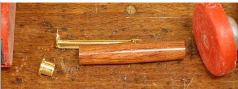
Mit einer Schraubzwinde wird zuerst das Oberteil montiert. Der Deckel wird zusammen mit dem Klipp aufgedrückt.
