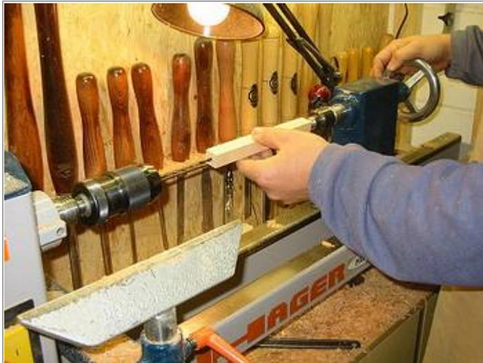
Für diesen Zwecke habe ich mir einen extra langen 4 mm Bohrer gekauft. (Gesamtlänge des Bohrers 119 mm.)
