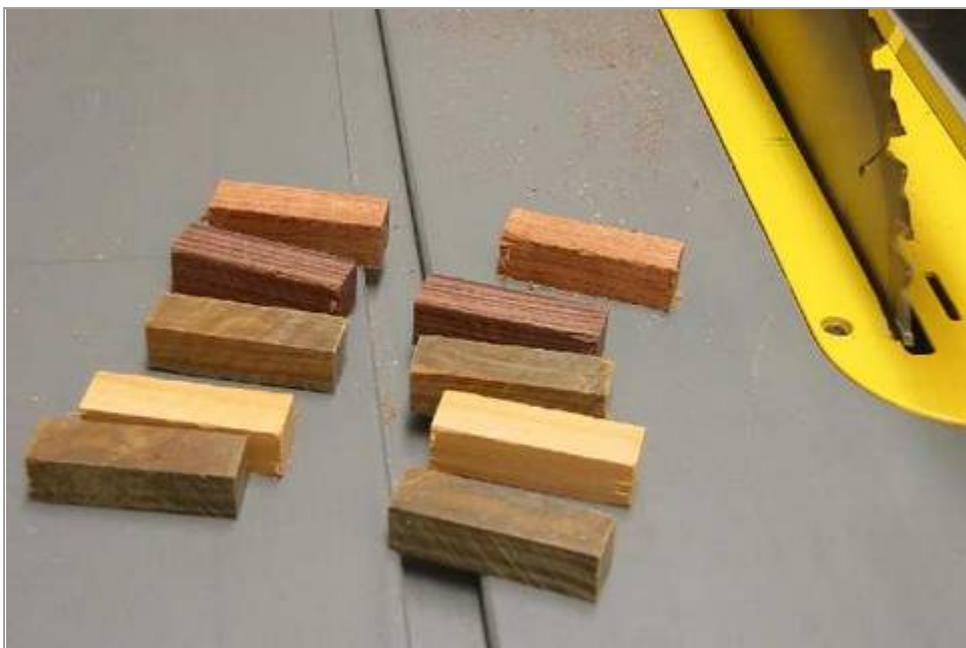
Im nächsten Arbeitsgang werden die Stücke auf eine Länge von etwa 55 mm gebracht. Damit die Holzstruktur auch im fertigen Stift durchläuft, sollte man wenn möglich, die Stücke so zusammenlegen, wie sie auch am Baum gewachsen sind.
