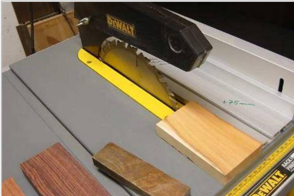
Mit der Tischkreissäge schneide ich Stücke von etwa 15 x 15 mm. Man kann also sehr gut auch kleine Reste verwenden.
