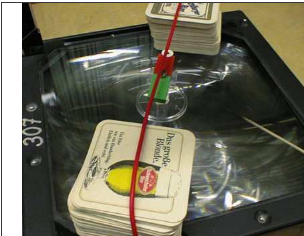
Kabel oberhalb des Magneten, kein Strom fließt
