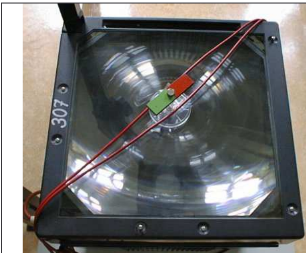
Zwei Schleifen, kein Strom fließt
