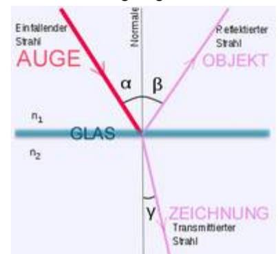
Reflexionsgesetz Einfallswinkel = Ausfallswinkel. Beim Perspektografen muss der Sucher dementsprechend mit der Flügelschraube so geschwenkt werden, dass beide Lichtanteile gleich groß sind, sodass sowohl die eigene Zeichnung wie auch der anvisierte Gegenstand sichtbar sind.
