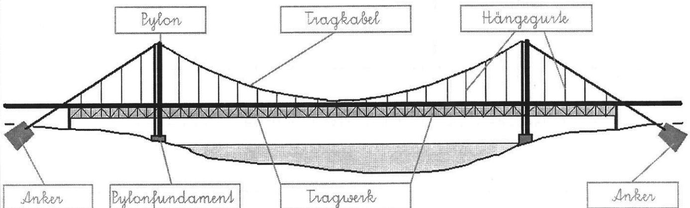
Anker - Hängegurte - Pylon - Pylonfundament - Tragkabel - Tragwerk
