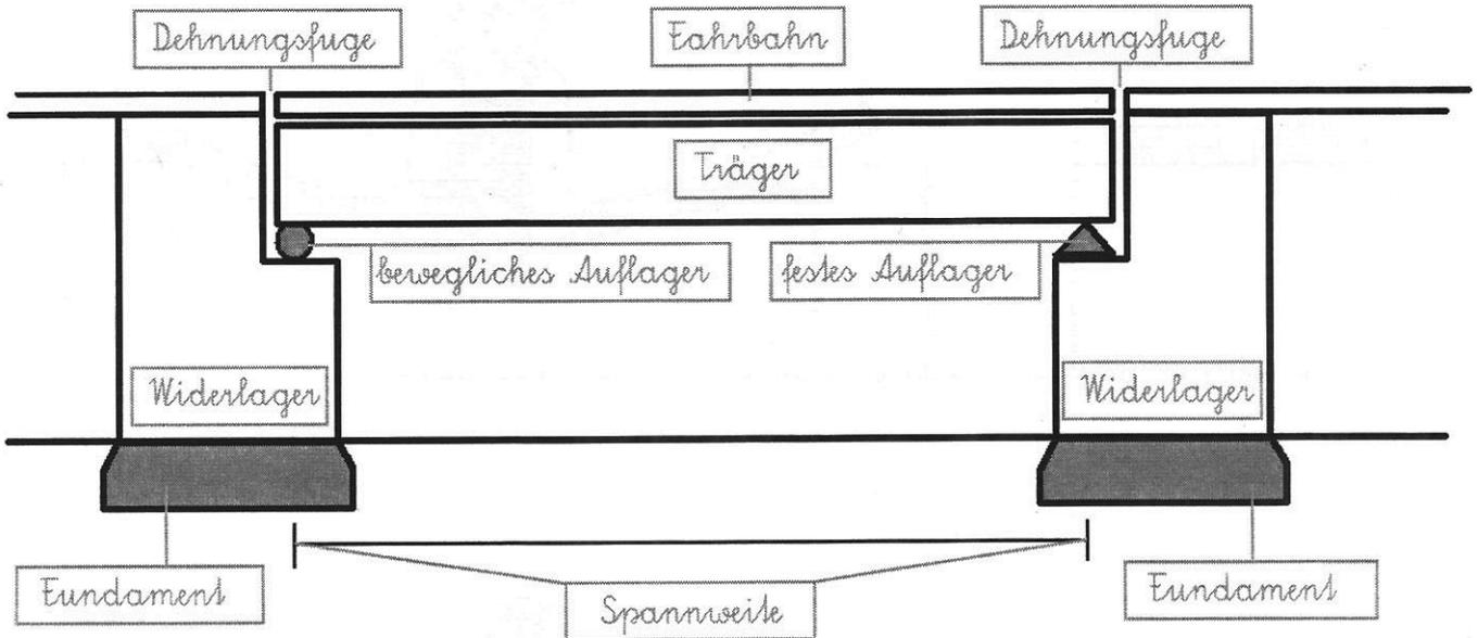
bewegliches Auflager - Dehnungsfuge - Fahrbahn - festes Auflager - Fundament - Spannweite
