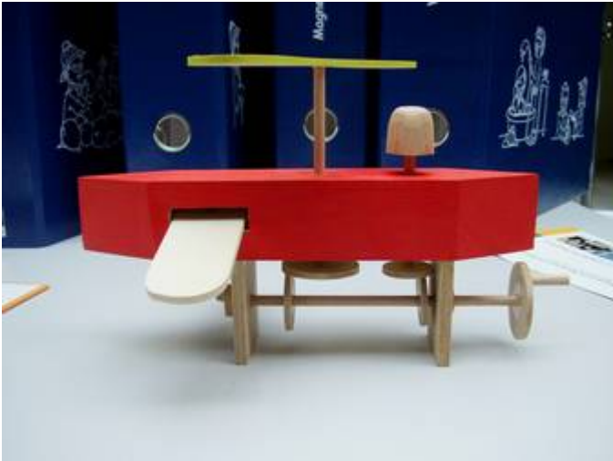
Mechanisches Theater": Planung und Realisierung eines „Flugmodells“ mit Nocken- und Reibradgetriebe, 2.Sem. Hans Schiffinger
