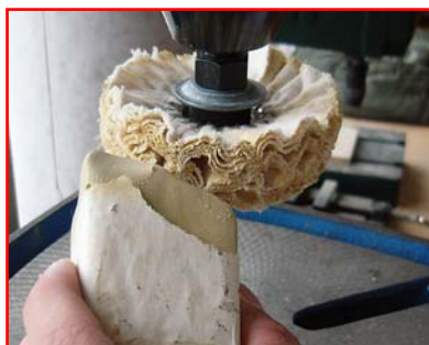
5. Polierwachs auf die Polierscheibe auftragen
