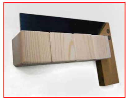
4. Holzquader mithilfe des Anschlagwinkels prüfen
