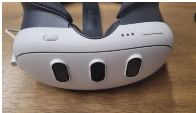
Drehregler und Lautstärketaste an der Unterseite des Headsets (Bildquelle: SPS)
