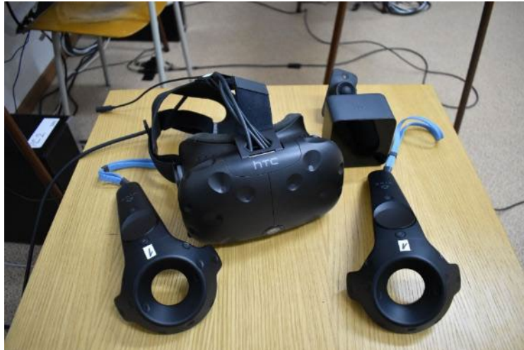
Head-Mounted-Display HTC Vive mit Controllern für haptisches Feedback und Tracking-Station (Bildquelle: VReduMED)
