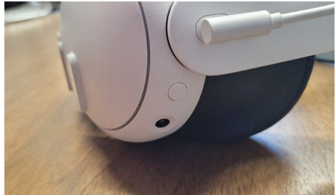
Ein-/Aus-Taste (in der Mitte), angeschlossenes USB-C-Kabel oben (Bildquelle: SPS)
